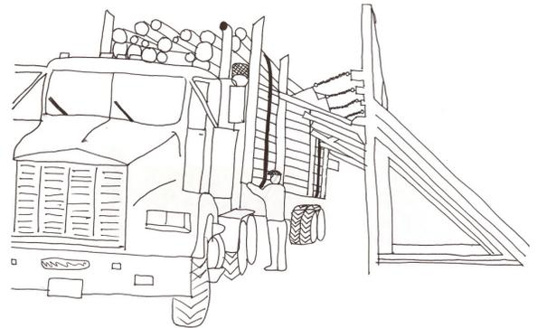
Si no hay una estación sin ataduras, no afloje los amarres sin el apoyo de una máquina de descarga (afianzada sobre la carga) a menos de que los troncos estén claramente más abajo de los soportes y apoyados por al menos dos apoyos.
